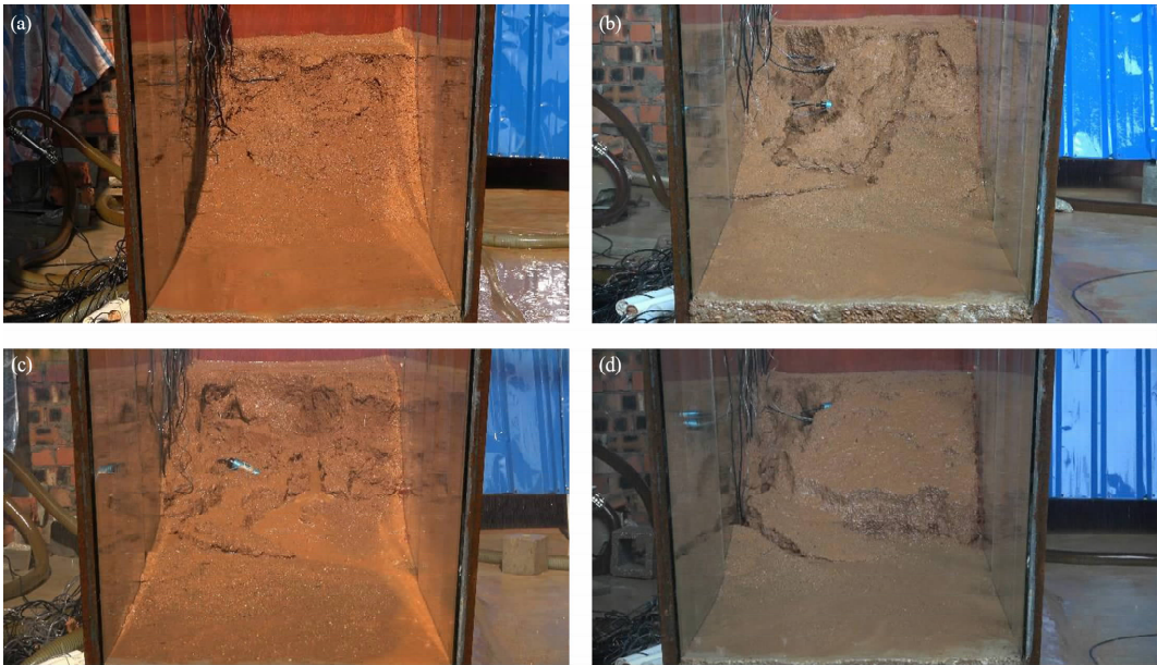
图 2 边坡失稳现象: (a) 试验 1; (b) 试验 2; (c) 试验 3; (d) 试验 4
