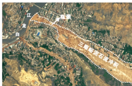
图9 建筑物挤占沟道导致行洪通道出现瓶颈
