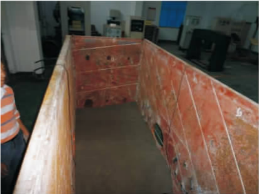
图 11 围岩的分层浇筑 Fig. 11 Stratified rock pouring
