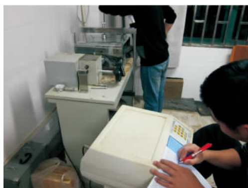
图 1 STJY-5 型土工合成材料直剪仪 Fig. 1 STJY-5 geosynthetic direct shear apparatus
