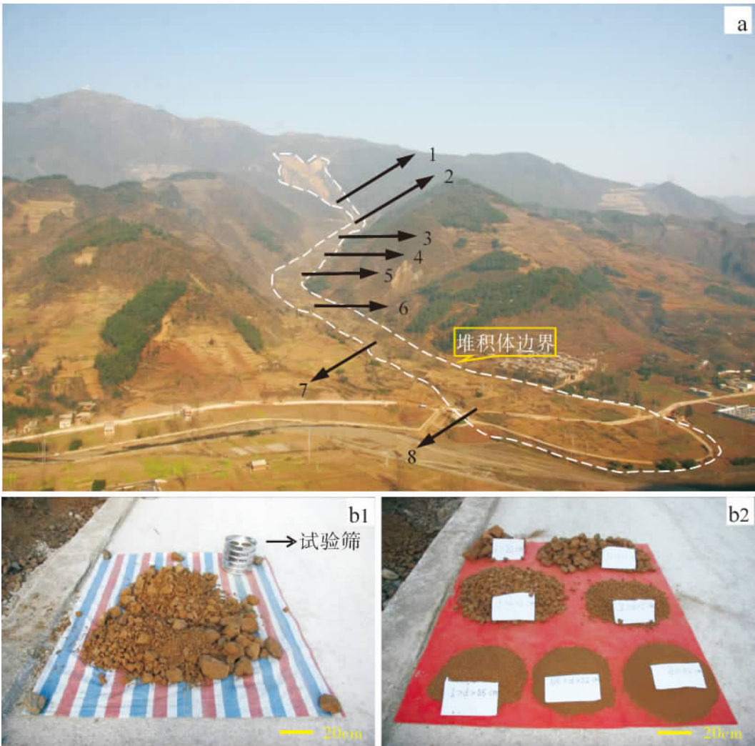
图 3 筛分试验取样点分布及 JP8 筛分前后示例
