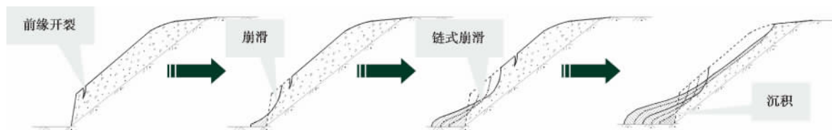
图2 坡面泥石流溯源挖掘演化模式
