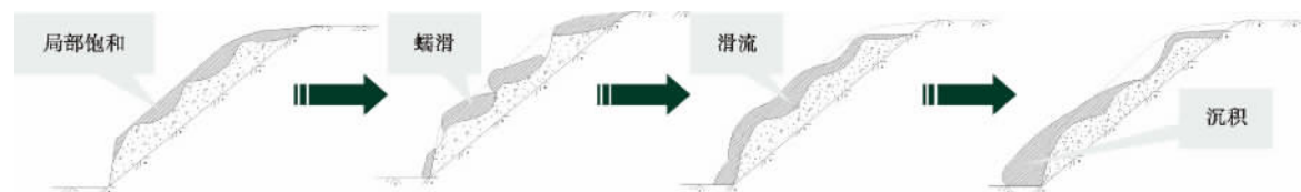
图3 坡面泥石流局部饱和孕滑演化模式
