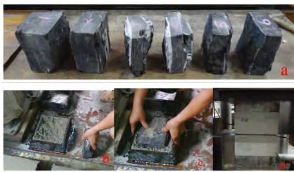
图3 试样的浇筑
