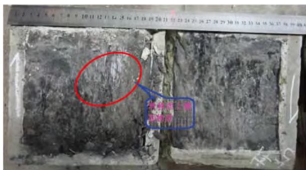
图2 试样破坏后及表面镜面物质
