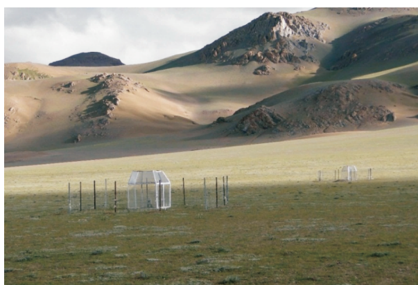
图2 布设在申扎高寒草原与湿地生态系统观测试验站的开顶箱(OTC)
