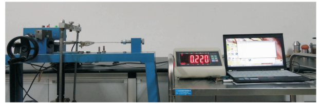
图1 植物根系抗拉试验装置
