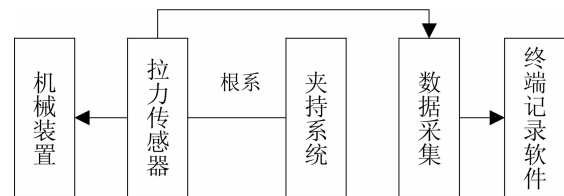
图2 根系抗拉试验测试示意图
