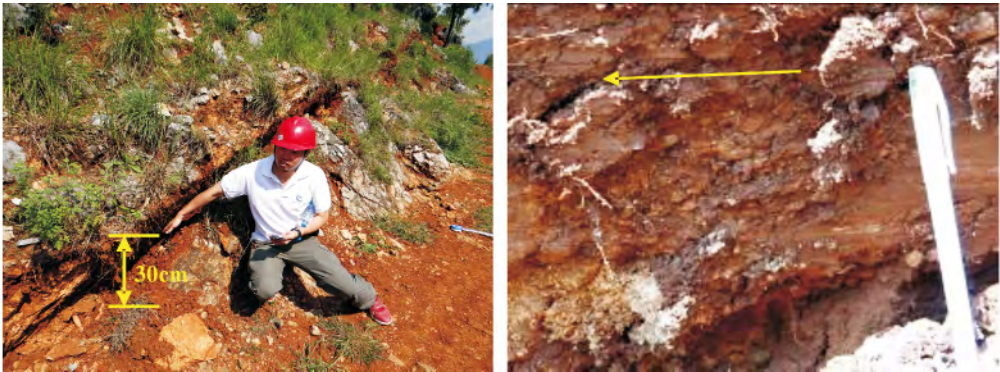
a 呈张裂性质的平直裂缝( 镜向南东) b 裂面上的擦痕 镜头指示对盘运动方向( 镜向上盘)
