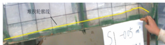
a、试验1滑坡体堆积形态
