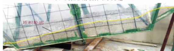
c、试验3滑坡体堆积形态
