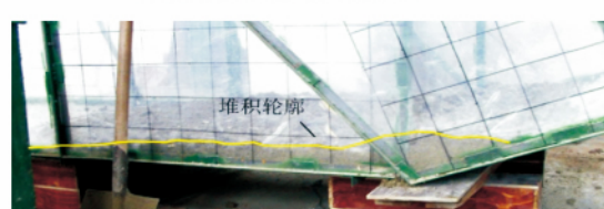
n、试验14滑坡体堆积形态
