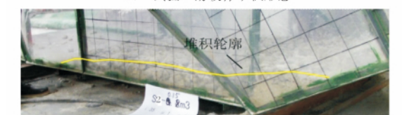
g、试验7滑坡体堆积形态
