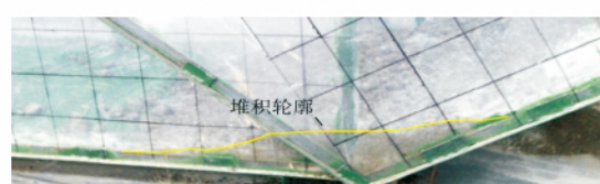
m、试验13滑坡体堆积形态
