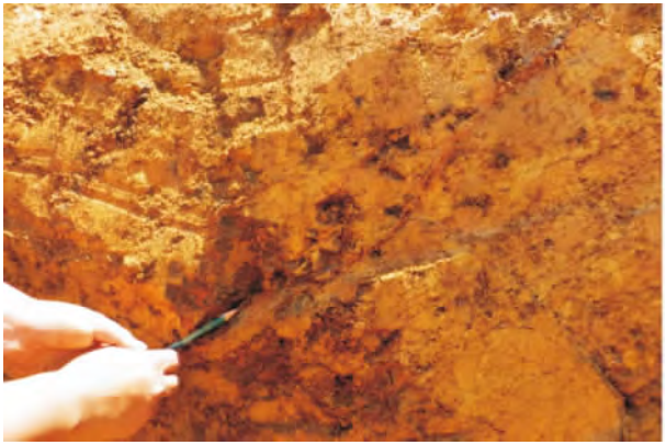
图 4 探槽中节理裂隙
