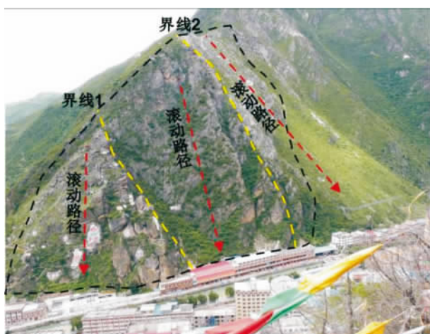
图 12 崩塌 I 区 II 区 III 区危岩体滚动滑动路径示意图
