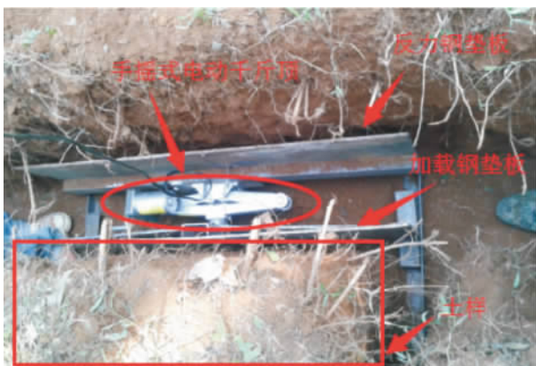
图1 现场试验试样及试验装置图
