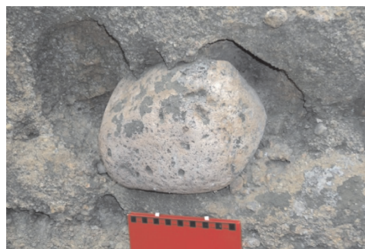
图 4 细粒物脱落砾石凸起
