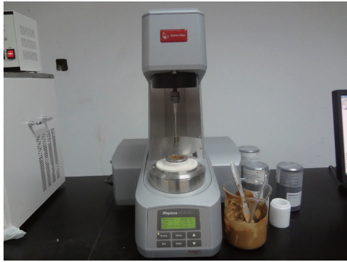
图 3 安东帕 MCR301 流变仪 Fig. 3 Antonpa MCR301 rheometer
