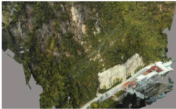
图 8 叠加无人机摄影数据的三维地质影像模型
