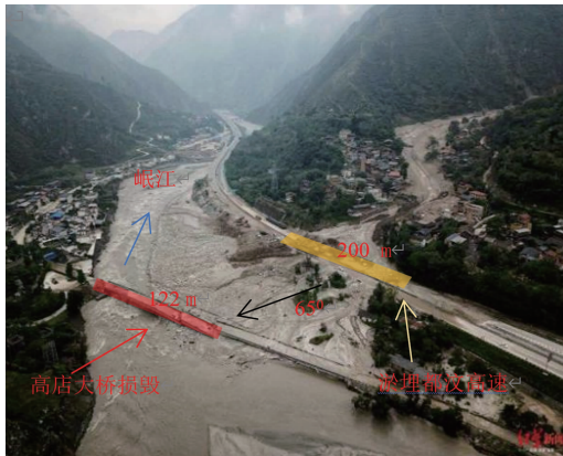
图 13 堵塞涵洞、冲断道路桥梁
