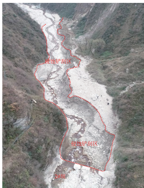
图 8 1#拦砂坝下游沟道铲刮侵蚀(8.20后)
