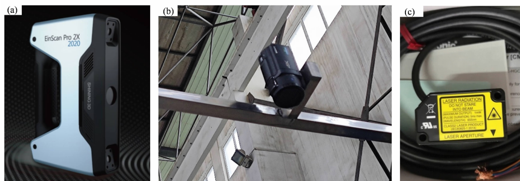
图3 数据测量装置:(a)3D扫描仪;(b)摄像机;(c)激光测距传感器
