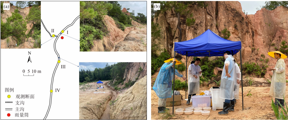
图3 径深崩岗泥砂流观测(采样)断面及野外现场:(a)观测(采样)断面示意图;(b)观测和采样工作照
