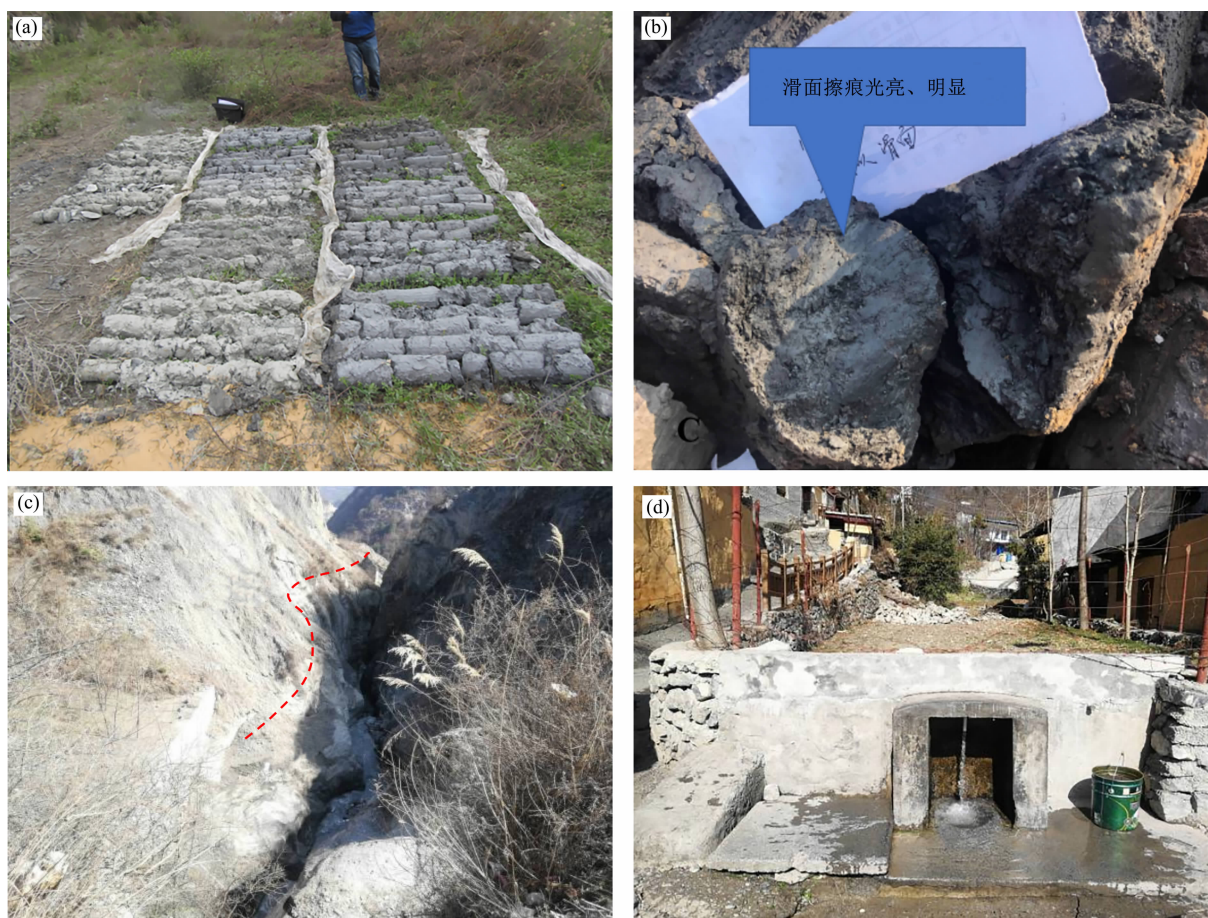
图 2 滑坡体结构特征: (a) 滑体岩芯特征; (b) 滑带土特征; (c) 滑坡体前缘基岩裸露; (d) 滑坡体中前缘出露泉水
