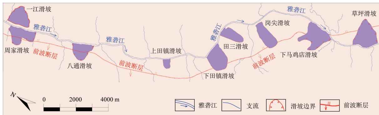
图1 卡拉水电站库区滑坡分布图
