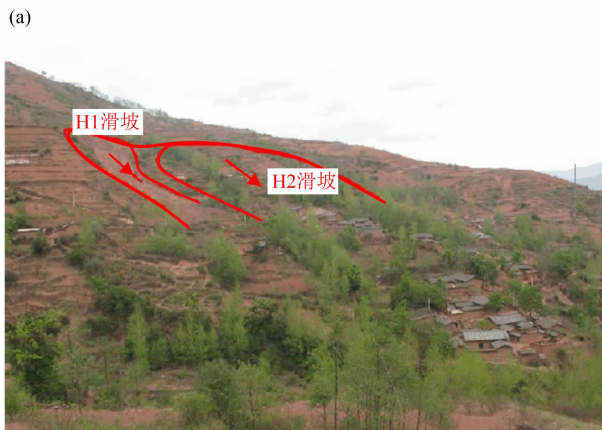
图10 波振村2组滑坡发育特征图
